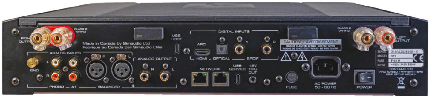
Die Rückseite ist vollgepackt mit digitalen und analogen Anschlüssen inklusive HDMI ARC, einem Phonoeingang, dem symmetrischen XLR-Eingang und dem Vorverstärkerausgang mit Cinchbuchsen. Rechts unten der harte Netzschalter.
