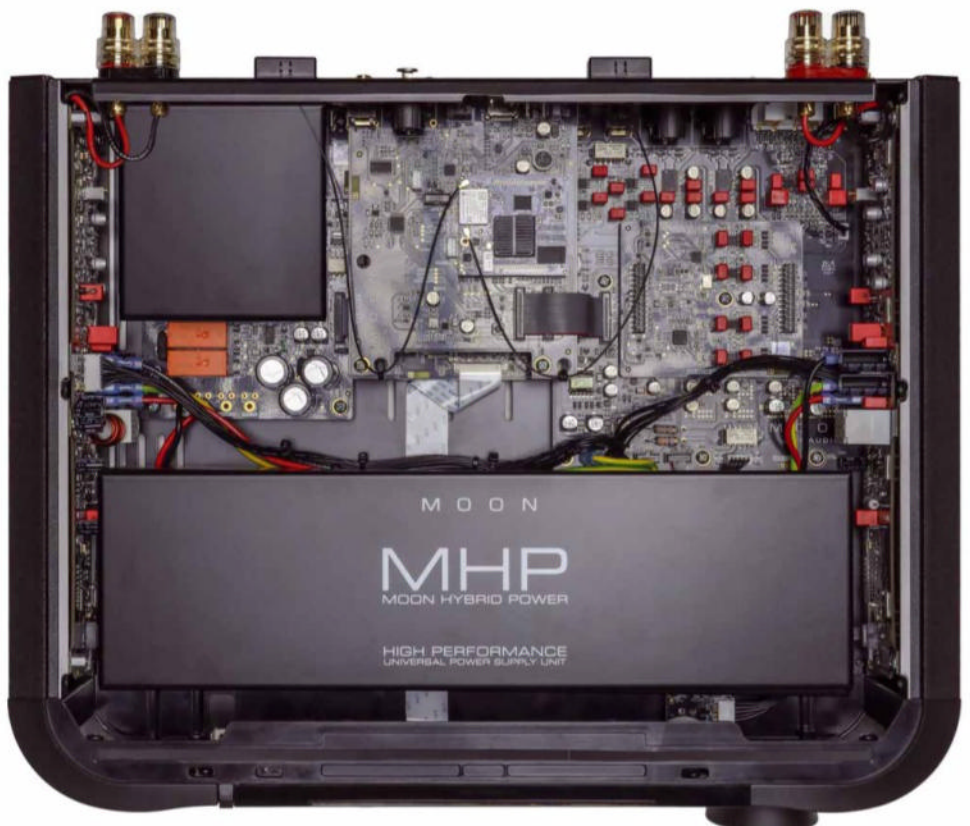
Hier sieht man noch einmal deutlich, welche Bedeutung das gut abgeschirmte MHP-Netzteil hat
