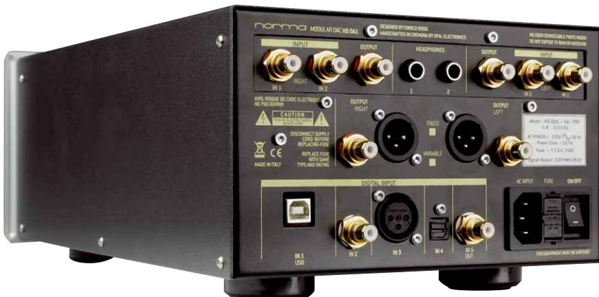
Da der Norma-DAC intern asymmetrisch arbeitet, macht es für den Anschluss an Endstufen tatsächlich Sinn, die Cinch- statt der XLR-Buchsen zu verwenden
