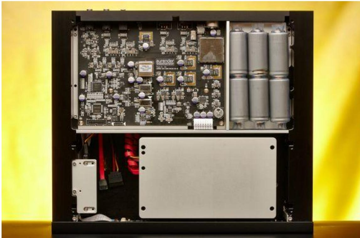
ÄUßERST PROFESSIONELL AUFGEBAUTES INNENLEBEN, DIE FESTPLATTEN SIND ZUSÄTZLICH GEDÄMPFT UND GEKAPSELT, UM AUCH DIE ALLERLETZTEN LAUFWERKSGERÄUSCHE ZU UNTERBINDEN. DIE AKKUS TRAGEN SICHER NICHT UNERHEBLICH ZUM HOHEN GEWICHT DES W20 BEI
