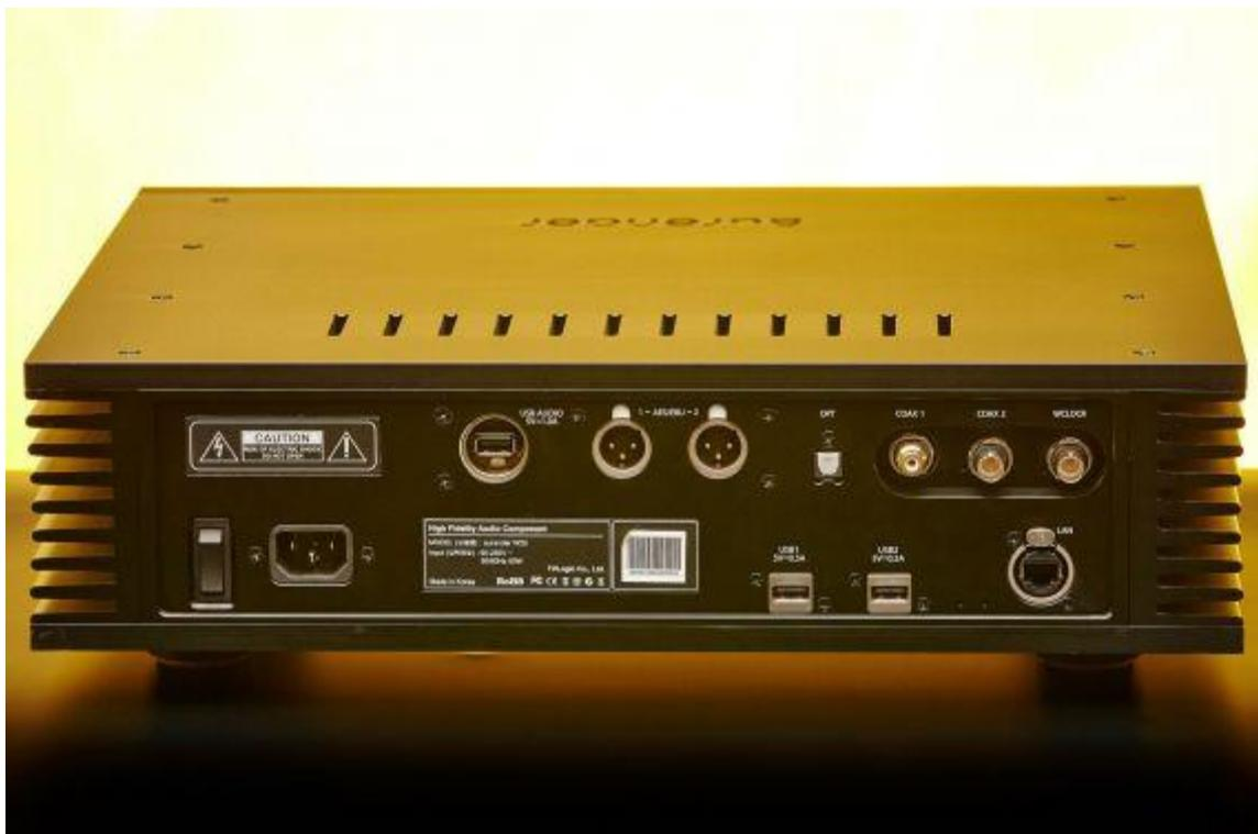
MITTLERWEILE GIBT ES FÜR DEN S/PDIF ANSCHLUSS AUCH DIE AMTLICHE BNC BUCHSE. EINE LAN-VERBINDUNG ZUM ROUTER IST IN JEDEM FALL ERFORDERLICH
