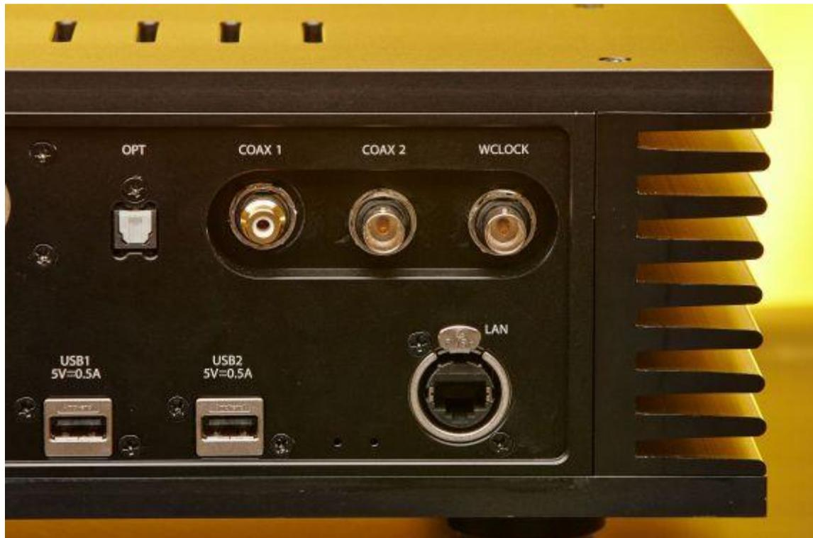
EINER GEHT NOCH! NÄMLICH DER BNC-ANSCHLUSS FÜR DIE WORDCLOCK. DIESE FUNKTION KONNTE LEIDER NICHT GETESTET WERDEN, WEIL KEIN GEEIGNETES GERÄT ZUR VERFÜGUNG STAND
