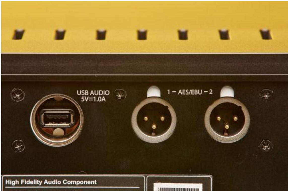
RECHTS DIE BEIDEN AES/EBU ANSCHLÜSSE FÜR DEN PROFESSIONELLEN DUALWIRE BETRIEB. FÜR OPTIMALEN USB BETRIEB HAT TVLOGIC EINEN SPEZIELL GEPUFFERTEN USB AUSGANG GESCHAFFEN
