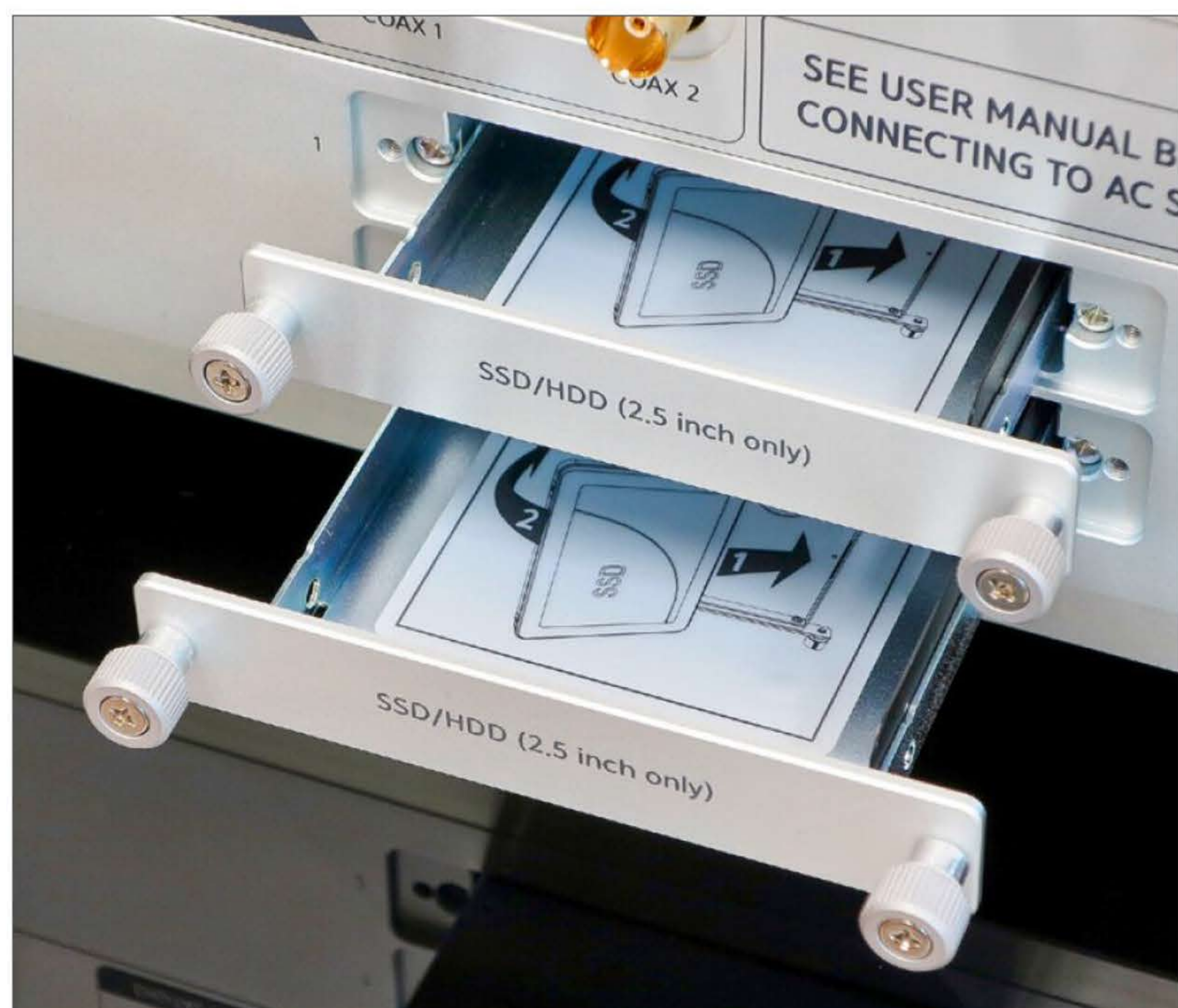
Zwei mit der Rückwand verschraubte Einschübe stehen für 2,5-Zoll-Festplatten bereit. Das erweitert den AP20 zum Musik-Server.
