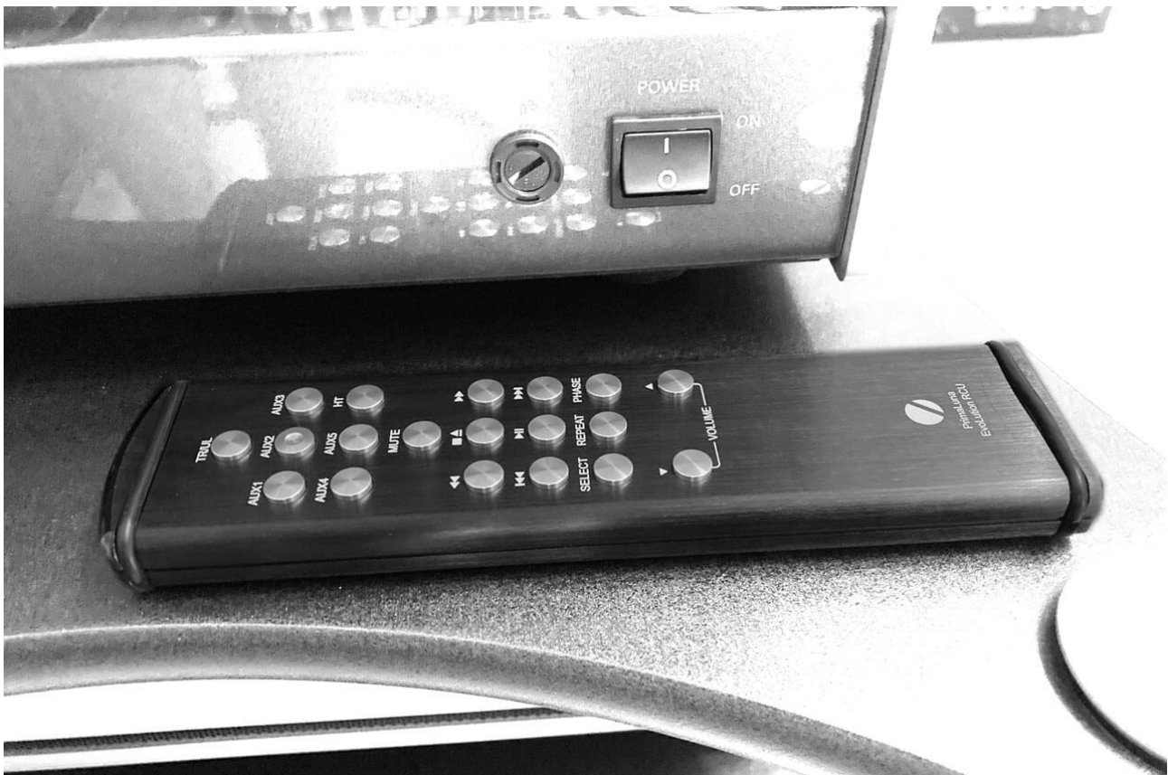
Mit dem aus dieser Perspektive linken Schalter auf der Fernbedienung des PrimaLuna EVO 300 lässt sich bequem zwischen Trioden- und Ultralinear-Modus wechseln
